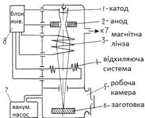
Рисунок 5.1 – Схема електронно-променевого устаткування
